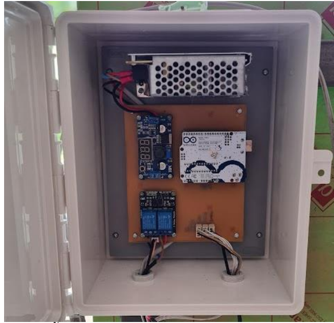
ภาพที่ 5 ผลการติดตั้งวงจรควบคุมการทำงานอ่างล้างมืออัตโนมัติ ตามที่ได้ออกแบบไว้
