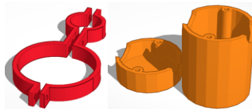
ภาพที่ 3 แบบร่างมิติ (3D) ชิ้นส่วนในการยึดจับ Sensor
