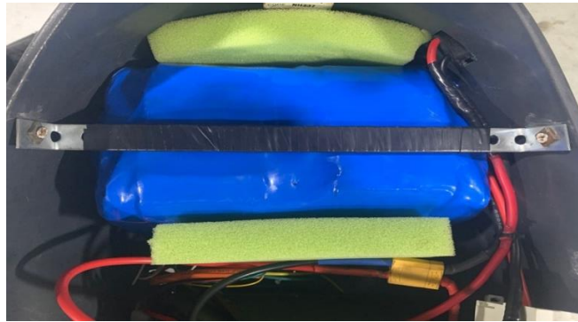
รูปที่ 3 แบตเตอรี่ลิเธียม 60 โวลต์ ความจุ 15 แอมป์
