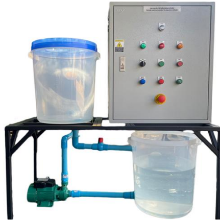
ภาพที่ 3 ชุดควบคุมระดับน้ำอัตโนมัติแจ้งเตือนผ่านโทรศัพท์มือถือที่สร้างเสร็จเรียบร้อยแล้ว
