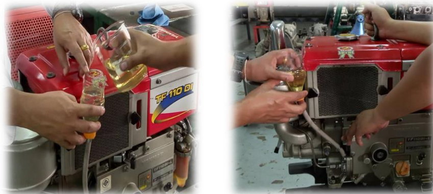
ภาพที่ 3 เครื่องยนต์ที่ใช้ในการทดสอบเป็นเครื่องยนต์ดีเซล 1 สูบ ยี่ห้อ ยันม่า TF110 Di
