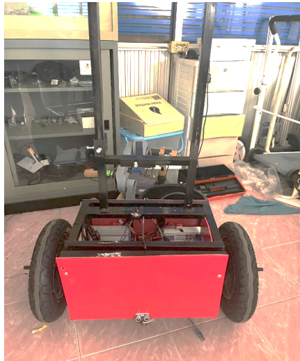
ภาพที่ 4 รถไฟฟ้าช่วยทุ่นแรงเคลื่อนที่ตามผู้ใช้งานที่สามารถใช้ร่วมกับรถเข็นทั่วไป
