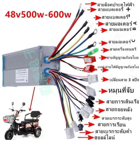
ภาพที่ 1 แสดงการต่อชุดควบคุมมอเตอร์รถไฟฟ้า
